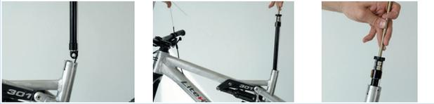
Abbildung 252: Kartusche Ventildeckel befestigen
