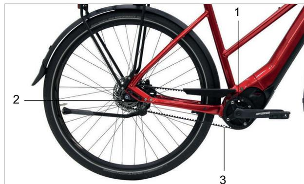
Abbildung 44: Schema Riemenantrieb
