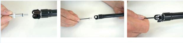
Abbildung 247: Kartusche Ventildeckel befestigen
