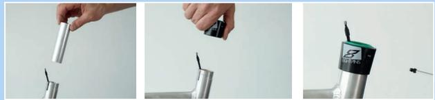
Abbildung 248: Gleitbuchse und Außenhülse einbauen
