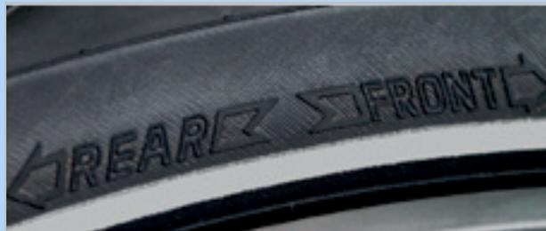
Abbildung 84: Laufrichtungspfeil auf MTB-Reifen
