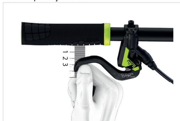
Abbildung 132: Positionierung Handbremse
