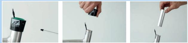
Abbildung 266: Außenhülse und Gleitbuchse ausbauen
