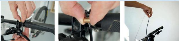
Abbildung 263: Fernbedienung lösen
