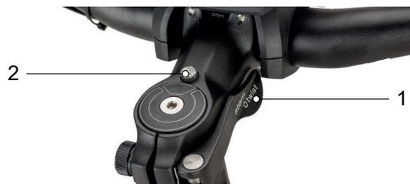
Abbildung 100: Vorbau, Ausführung II mit Spannhebel des Vorbau-Schnellspanners (1) und Entsperrknopf (2)
