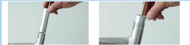
Abbildung 255: Gleitbuchsenrohr ins Sattelrohr stecken
