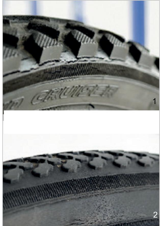
Abbildung 192: Beispiele für Ermüdungsrisse (1) und Alterungsrisse (2)
