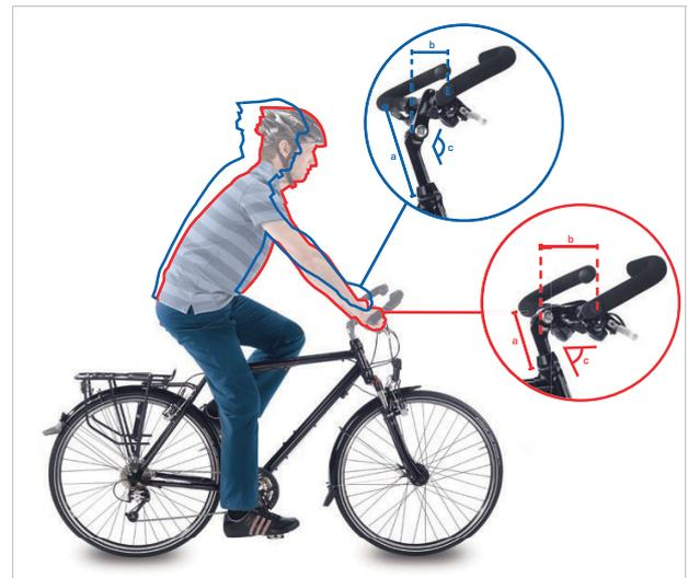
Abbildung 125: Citybike (blau) und Trekkingrad Position (rot) durch Winkeländerung
