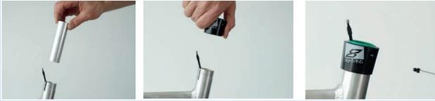
Abbildung 281: Gleitbuchse und Außenhülse einbauen
