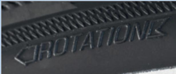
Abbildung 83: Laufrichtungspfeil
