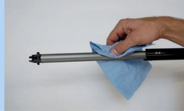
Abbildung 277: Längsführungsnut reinigen
