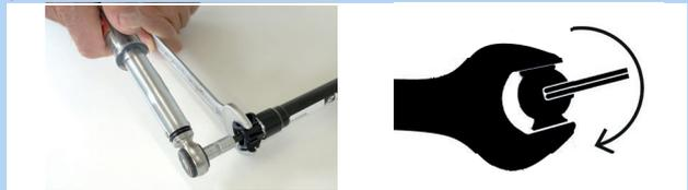
Abbildung 246: Im Uhrzeigersinn einstellen
