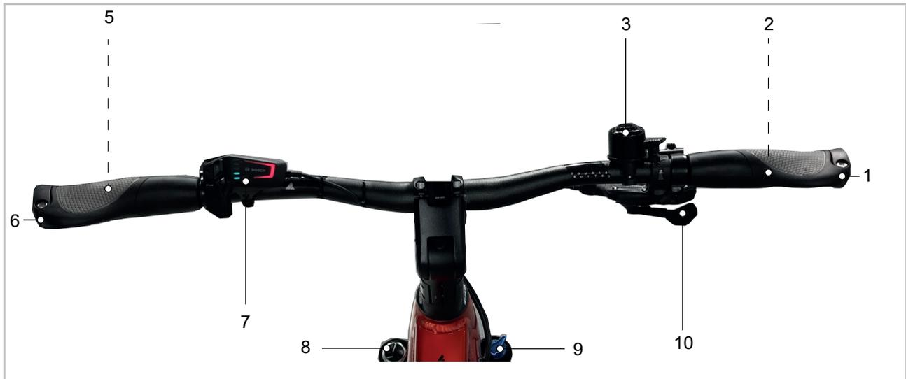
Abbildung 51: Detailansicht Lenker mit BOSCH LED Remote, Beispiel
