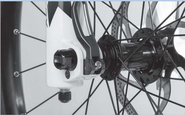
Abbildung 93: Perfekte Lage des Spannhebels
