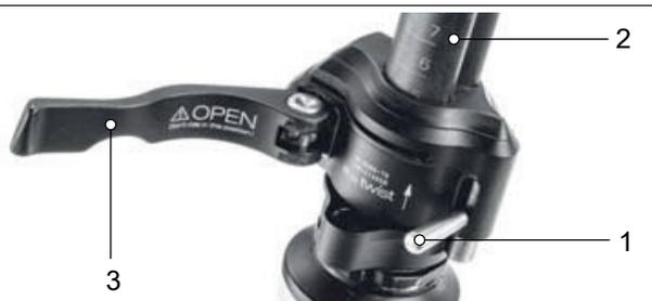
Abbildung 99: Geöffneter Spannhebel des Vorbau-Schnellspanners (3) am Vorbau (2), Ausführung I, mit Sicherungshebel am Vorbau (1)
