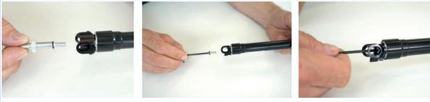
Abbildung 243: Kartusche Ventildeckel befestigen
