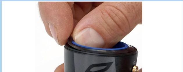
Abbildung 267: Dichtlippenring abziehen
