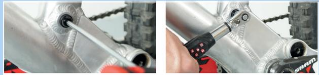
Abbildung 254: Postpin Achse befestigen
