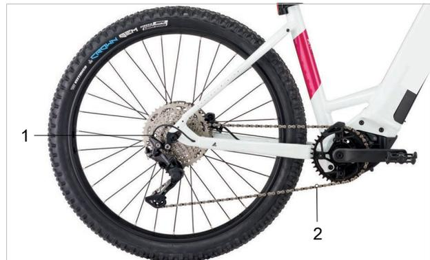
Abbildung 43: Schema Kettenantrieb mit Kettenschaltung
