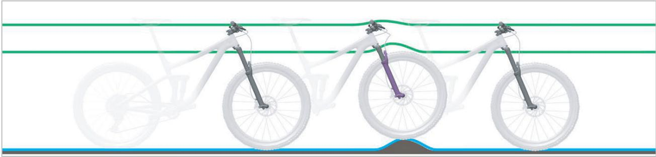
Abbildung 17: Optimales Fahrverhalten der Federgabel bei Unebenheiten
