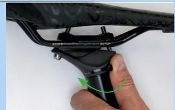
Abbildung 280: Höhenverstellung schließen
