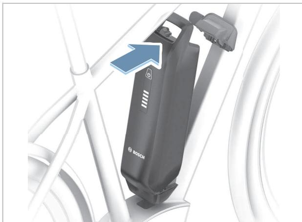
Abbildung 156: PowerPack Akku nach oben klappen
