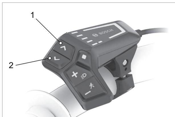
Abbildung 172: Lage Helligkeit erhöhen-Taste (2) und Helligkeit vermindern-Taste (1)
