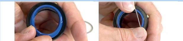
Abbildung 238: Abstreifer einlegen und befestigen
