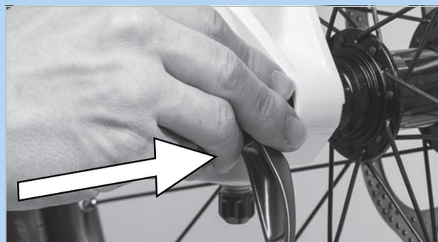
Abbildung 96: Schnellspanner in Pfeilrichtung einschieben
