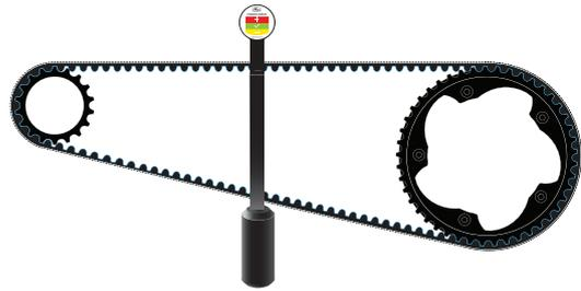
Abbildung 212: Aufgehängter Messstab
