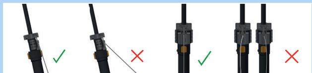
Abbildung 251: Korrekter und falscher Bowdenzug
