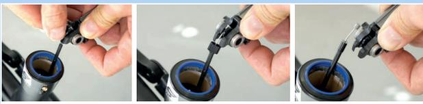
Abbildung 265: Bowdenzug entfernen
