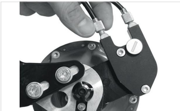
Abbildung 218: ROHLOFF-Naben Versionen mit externer Schaltansteuerung haben die Zugeinsteller an der Seilbox, die sich auf der linken Seite befindet
