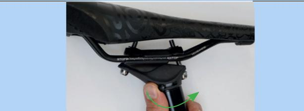
Abbildung 275: Höhenverstellung öffnen
