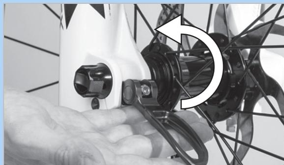
Abbildung 92: Schnellspannhebel in Pfeilrichtung drücken
