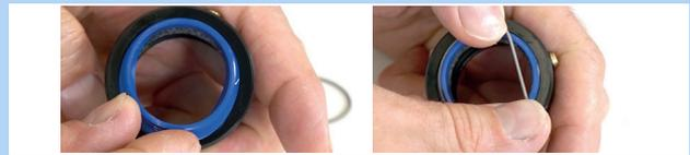
Abbildung 273: Abstreifer einlegen und befestigen
