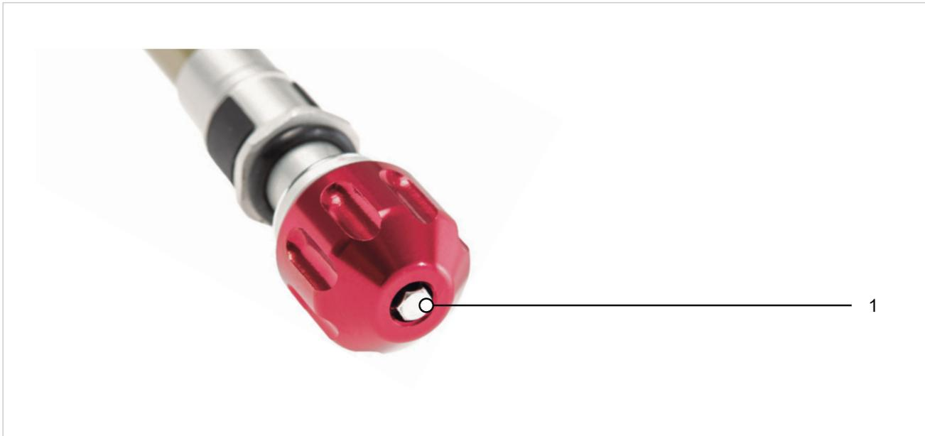
Abbildung 137: Beispiel SR SUNTOUR Zugstufen-Einsteller (Federgabel) (1)
