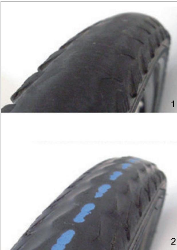
Abbildung 191: Reifen ohne Profil, der gewechselt werden kann (1) und Reifen mit durchscheinendem Pannenschutz (2), der gewechselt werden muss
