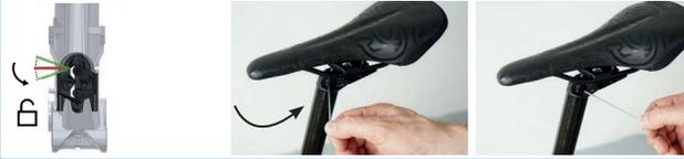
Abbildung 224: Höhenverstellungsbetätigung in „Geöffnete Stellung“ bringen
