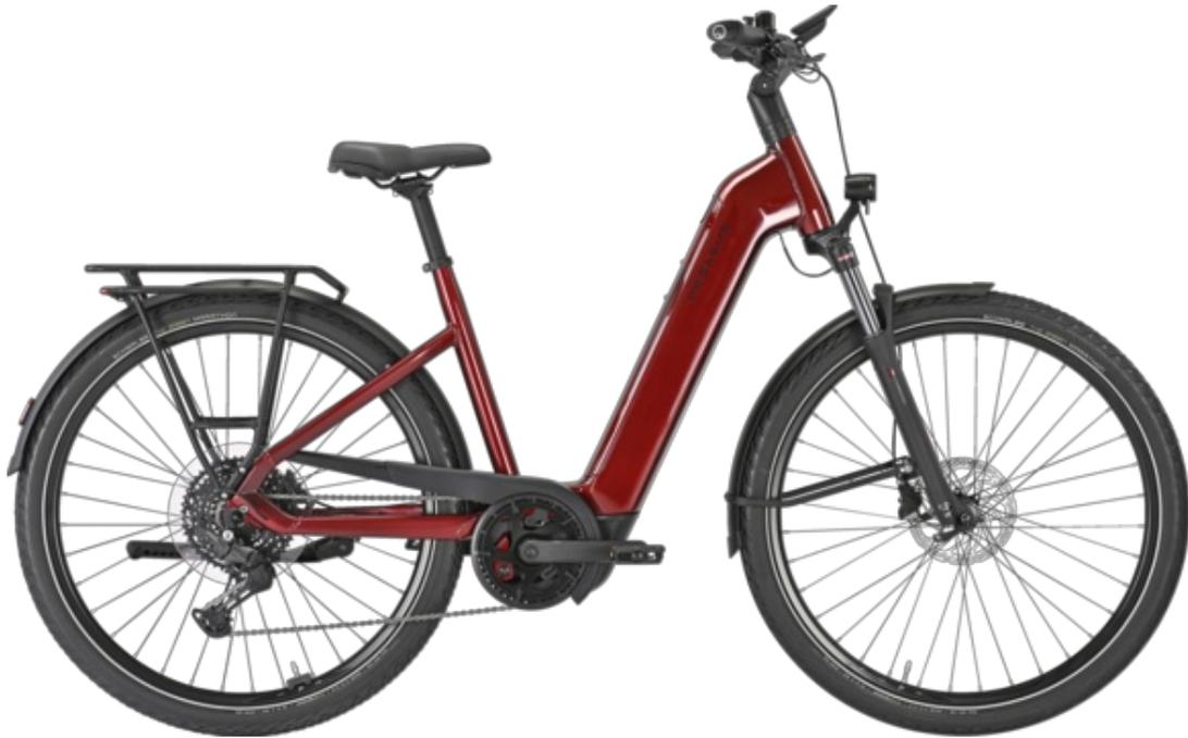
Das PREMIO EVO 10 LITE legt als aktualisiertes Jubiläumsmodell einen besonders starken Auftritt hin. Es ist erhältlich in drei Rahmenformen und wahlweise mit den zwei neuen Akku-Größen 600 und 800 Wh. Der formschöne Aluminiumrahmen, der im sogenannten Monocoque Casting Verfahren hergestellt wird, verfügt über eine komplett interne Leitungsführung ab dem Cockpit; für Komfort sorgen eine Luftfedergabel mit 100 mm Weg, die breiten Reifen und eine angenehm aufrechte Sitzhaltung.
