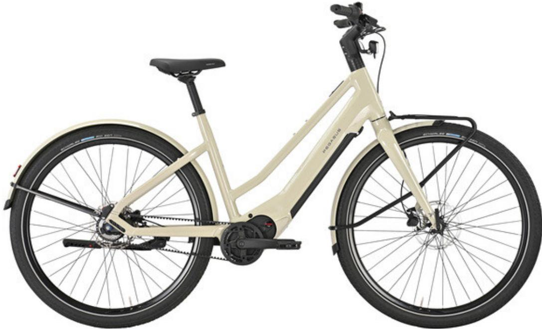
PEGASUS Versario EVO ist der Name eines zeitgemäßen, formschönen Urban-Bikes, dessen schubstarker Brose-Motor mit drei Akku-Varianten (555, 740 und 925 Wh) auf mittlere und ebenso super lange Reichweiten abgestimmt werden kann. Besondere Details wie die Schutzbleche in Rahmenfarbe und eine Starrgabel mit Frontgepäckträger bieten Formschönheit und Funktionalität im städtischen Alltag, in dem sich auch die 5-Gang-Getriebe-Nabe sowie der Zahnriemen durch minimalen Wartungsaufwand bewähren.
