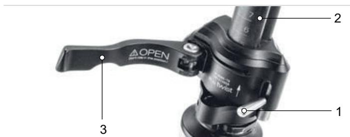
Abbildung 40: Geöffneter Spannhebel des Vorbau-Schnellspanners (3) am Vorbau (2), Ausführung I, mit Sicherungshebel am Vorbau (1)
