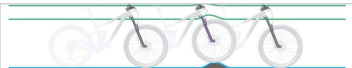
Abbildung 11: Optimales Fahrverhalten der Federgabel bei Unebenheiten
