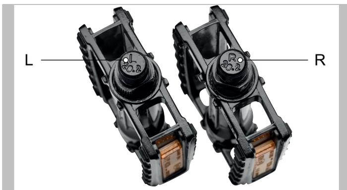
Abbildung 42: Beispiel Kennzeichnung von Pedalen
