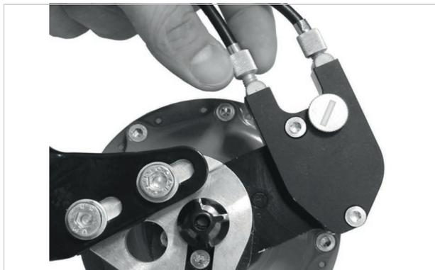
Abbildung 29: ROHLOFF-Naben Versionen mit externer Schaltansteuerung haben die Zugeinsteller an der Seilbox, die sich auf der linken Seite befindet
