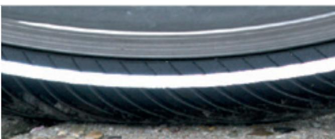
Abbildung 58: Korrekter Fülldruck. Der Reifen ist unter der Last des Körpergewichts kaum verformt
