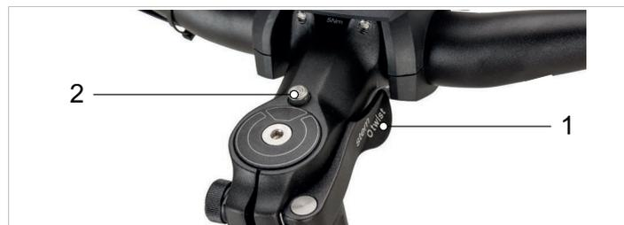
Abbildung 41: Vorbau, Ausführung II mit Spannhebel des Vorbau-Schnellspanners (1) und Entsperrknopf (2)
