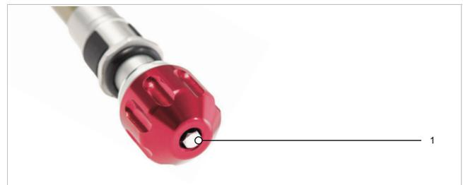
Abbildung 133: Beispiel SR SUNTOUR Zugstufen-Einsteller (Federgabel) (1)
