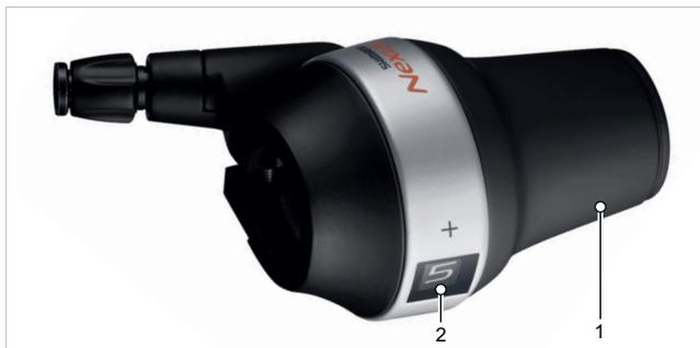
Abbildung 38: Dreh-Schaltgriff SHIMANO NEXUS SL-C7000-5
