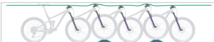
Abbildung 12: Optimales Fahrverhalten der Federgabel
