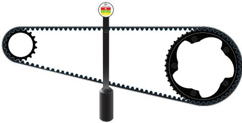
Abbildung 23: Aufgehängter Messstab
