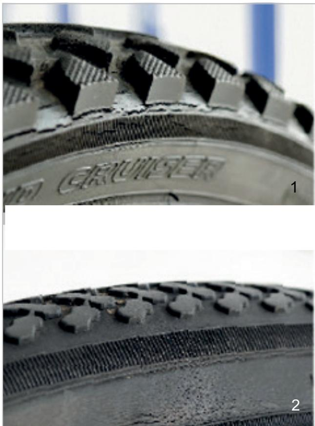
Abbildung 5: Beispiele für Ermüdungsrisse (1) und Alterungsrisse (2)
