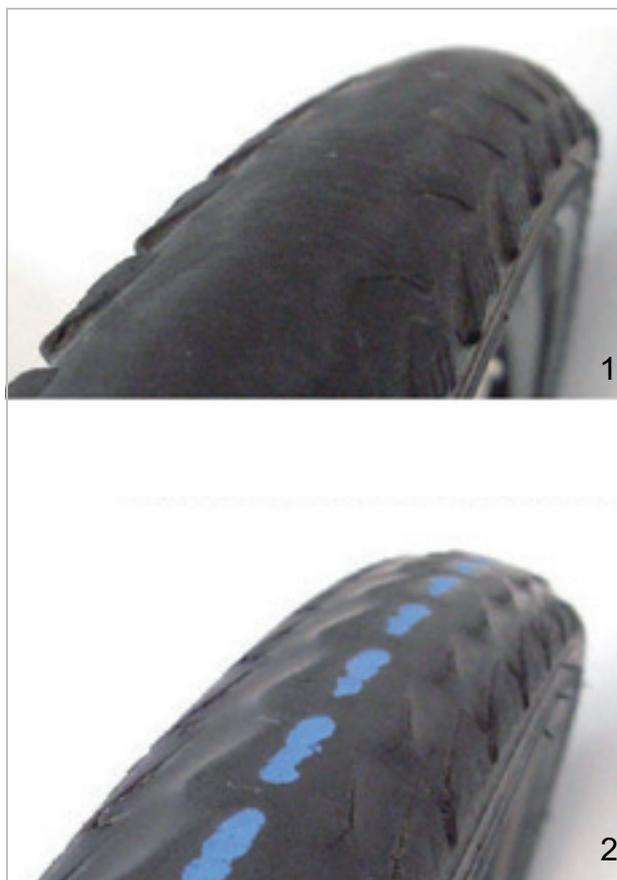
Abbildung 4: Reifen ohne Profil, der gewechselt werden kann (1) und Reifen mit durchscheinendem Pannenschutz (2), der gewechselt werden muss
