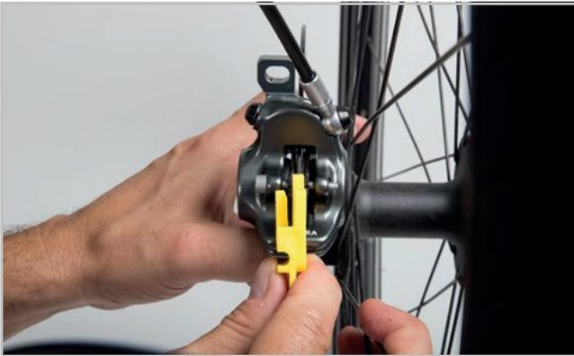
Abbildung 6: Bremsbelag im eingebauten Zustand mithilfe der Transportsicherung prüfen
